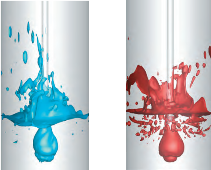
Simulation der Flüssig-Gas-Grenzfläche beim Tauchlanceinsatz in metallurgischen Prozessen bei geringerer Viskosität (links) und höherer Viskosität (rechts)
