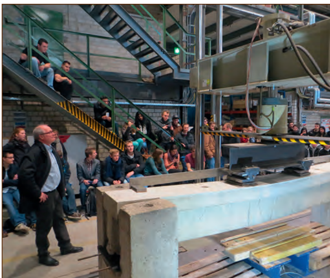
Abb. 5: Prof. Reinhard Maurer (Lehrstuhl Betonbau) führt den Studierenden des Bauingenieurwesens einen Belastungsversuch an einem Betonträger vor, Foto: Detlef Podehl
