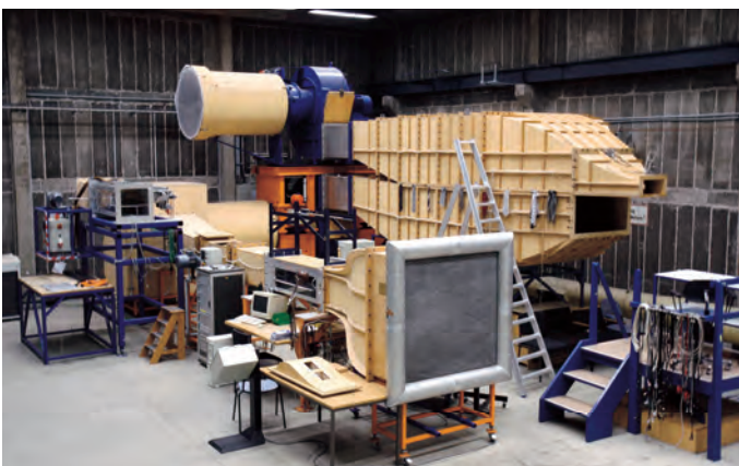
Großwindkanäle für die Untersuchung aktiver Beeinflussungsmöglichkeiten von Turbinenströmungen und Mischungsvorgängen
