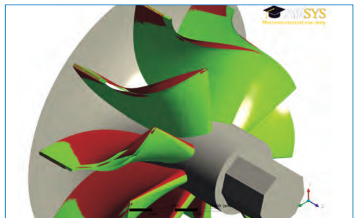
Simulation der Durchströmung eines Radialturbinen-Laufrades
