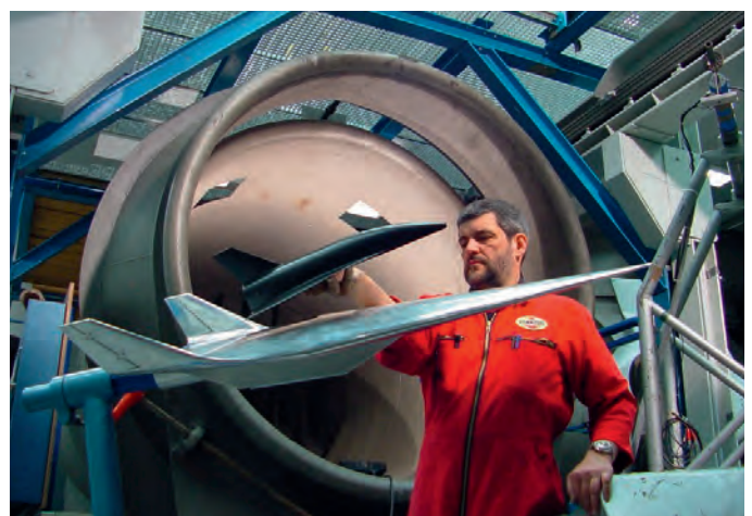
Abb. 4: Institutseigener Unterschall-Windkanal, hier Modell-Untersuchungen eines wiederverwendbaren Raumtransportsystems
