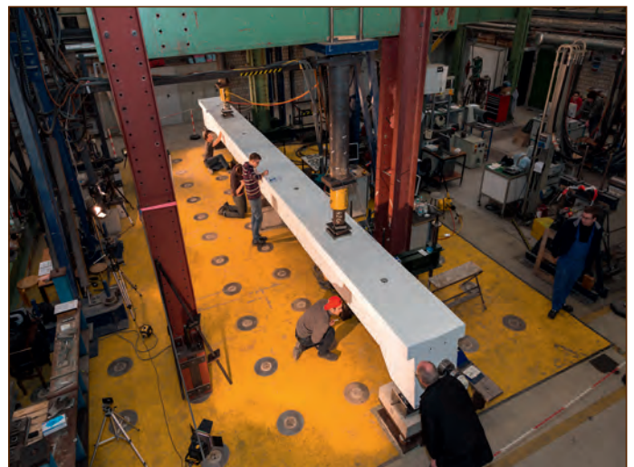
Abb. 8: Messungen an vorgespannten Betonträgern, Versuchsaufbau des Lehrstuhls Betonbau (Prof. Reinhard Maurer), Foto: Detlef Podehl
