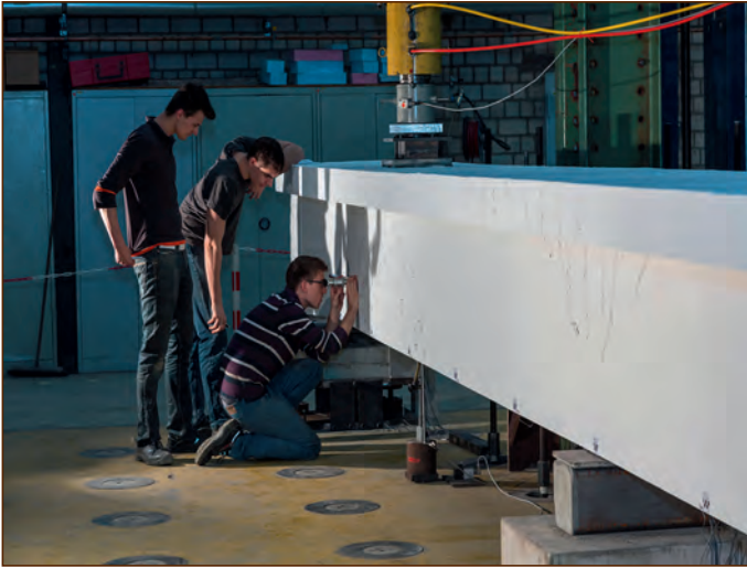
Abb. 9: Überprüfung der Rissbilder, Versuchsaufbau des Lehrstuhls Betonbau (Prof. Reinhard Maurer), Foto: Detlef Podehl
