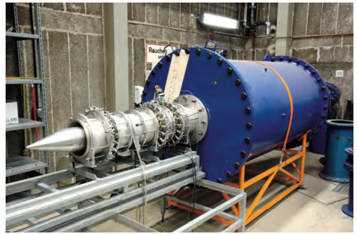
Ringgitterwindkanal zur Untersuchung rotierender Instabilitäten
