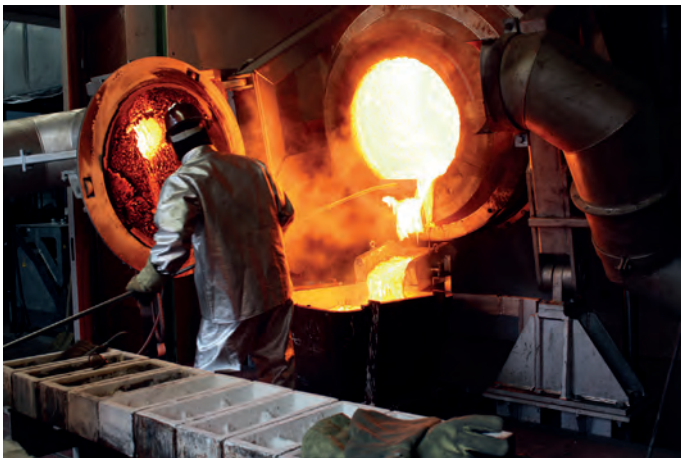
Abb. 7: TBRC Bild von den WEEE-Recycling Versuchen
