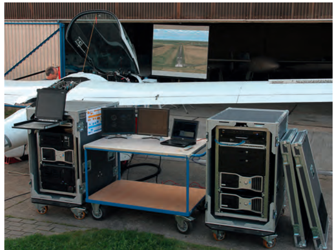
Bild 5: Hardware-in-the-Loop Simulator beim Test des Flugreglers
