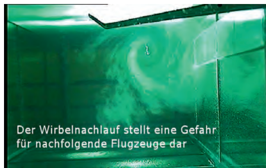
Abb. 6: Untersuchungen zur Wirbelschleife an einem Halbmödel im institutseigenen Wasserschleppkanal
