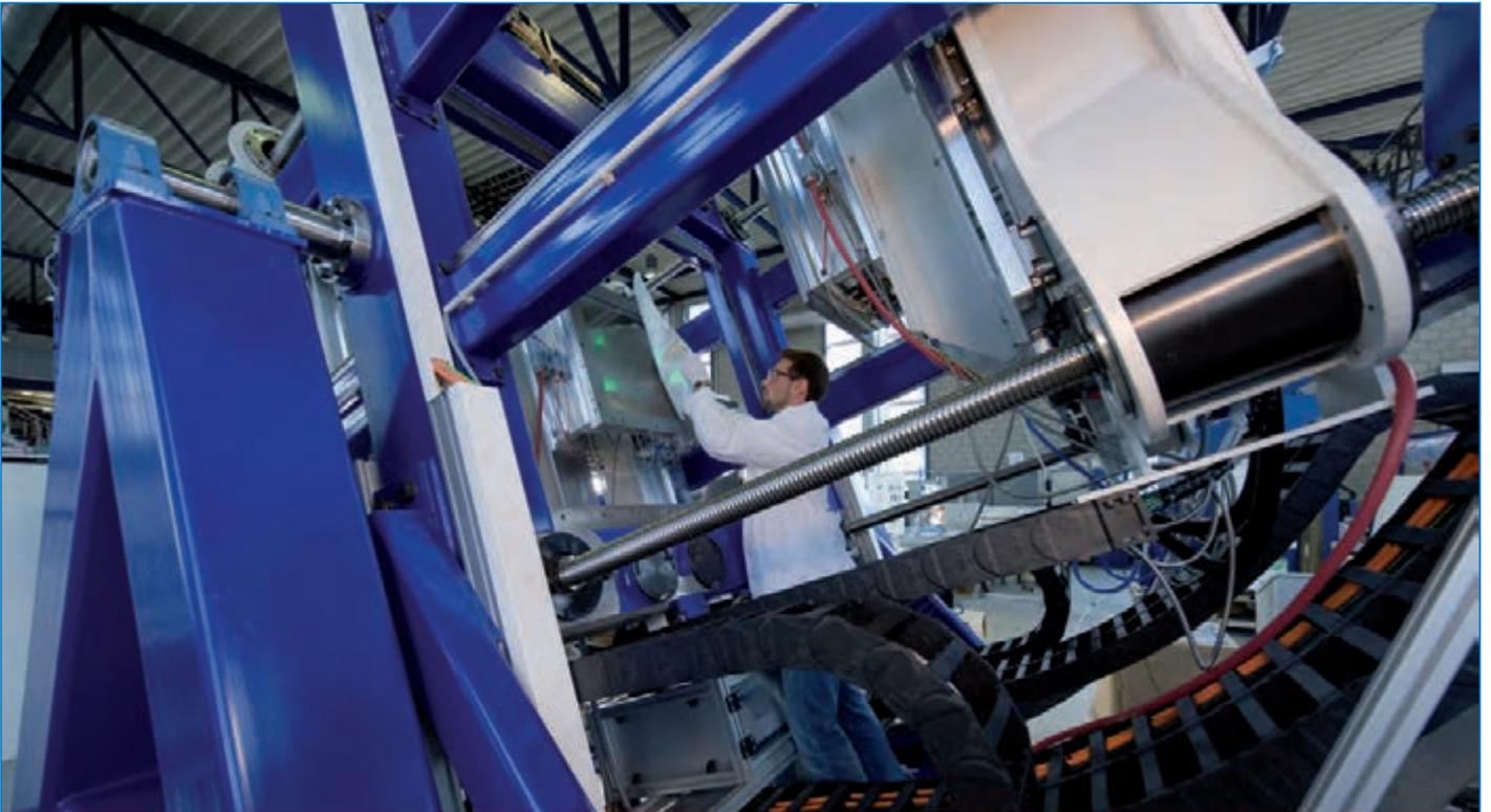
Das IKV arbeitet, wie hier im Bereich der faserverstärkten Kunststoffe (FVK), an innovativen Prozessen und neuen Technologien. Um die FVK auch für die Großserie konkurrenzfähig zu machen, müssen die Zykluszeiten reduziert werden. Auf diesem Weg ist die Spaltimprägierung ein vielversprechendes patentiertes Werkzeug- und Verfahrenskonzept. (IKV/Winandy)
