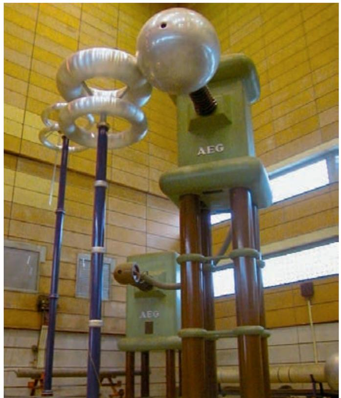
1,2-Millionen-Volt Wechselspannungstransformatorkaskade in der Großen Hochspannungshalle
