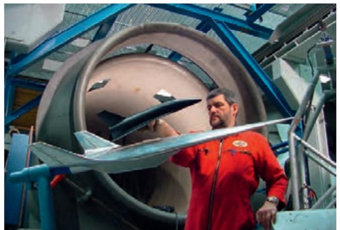
Abb. 4: Institutseigener Unterschall-Windkanal, hier Modell-Untersuchungen eines wiederverwendbaren Raumtransportsystems
