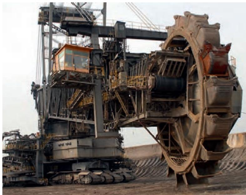
Schaufelradbagger im Tagebau Welzow-Süd (Foto: C. Nicolai)
