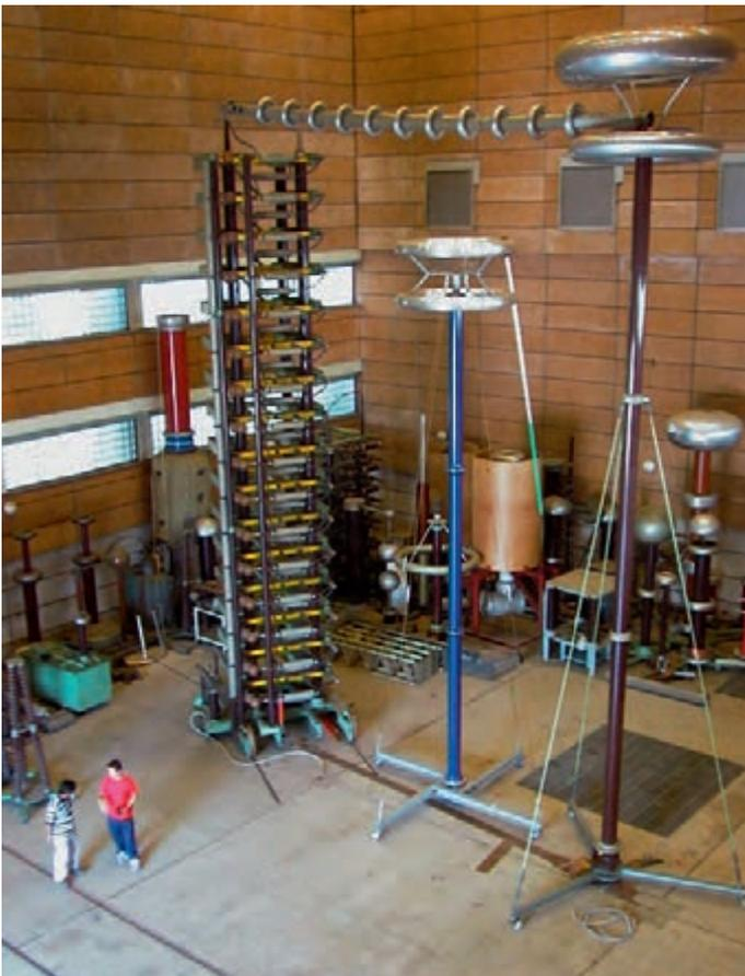
3,2-Millionen-Volt-Stoßspannungsgenerator in der Großen Hochspannungshalle
