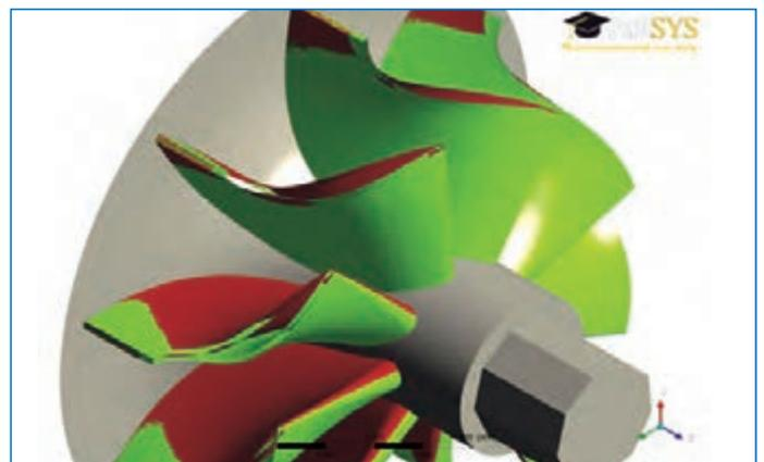
Simulation der Durchströmung eines Radialturbinen-Laufrades
