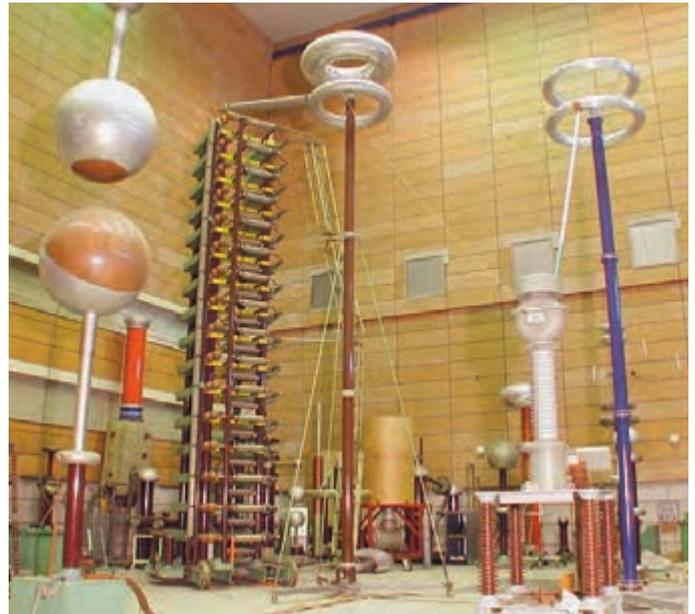
Stoßspannungsprüfungen an einem Messwandler
