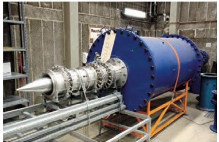
Ringgitterwindkanal zur Untersuchung rotierender Instabilitäten
