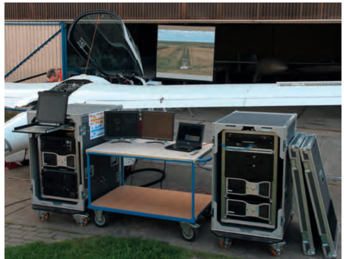
Bild 5: Hardware-in-the-Loop Simulator beim Test des Flugreglers
