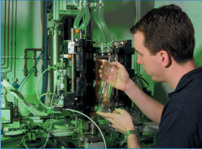
Die ersten Ideen zur Funktionalisierung von Kunststoffoberflächen mittels Plasma, heute unerlässlicher Garant für den Geschmack diverser Getränke aus PET-Flaschen, wurde bereits 1986 zum Patent angemeldet. Der Fokus der Forschungsarbeiten zur Plasmatechnologie liegt seither auf der Erzeugung neuartiger Oberflächeneigenschaften. Damit lassen sich bestimmte Eigenschaften der Kunststoffe, wie etwa unzureichende Kratzfestigkeit oder hohe Gasdurchlässigkeit optimal ausgleichen. (IKV/Winandy)
