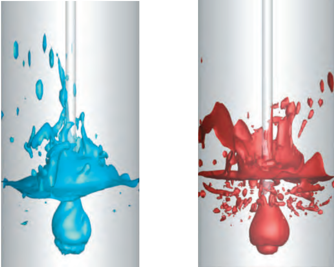
Simulation der Flüssig-Gas-Grenzfläche beim Tauchlanzeneinsatz in metallurgischen Prozessen bei geringerer Viskosität (links) und höherer Viskosität (rechts)
