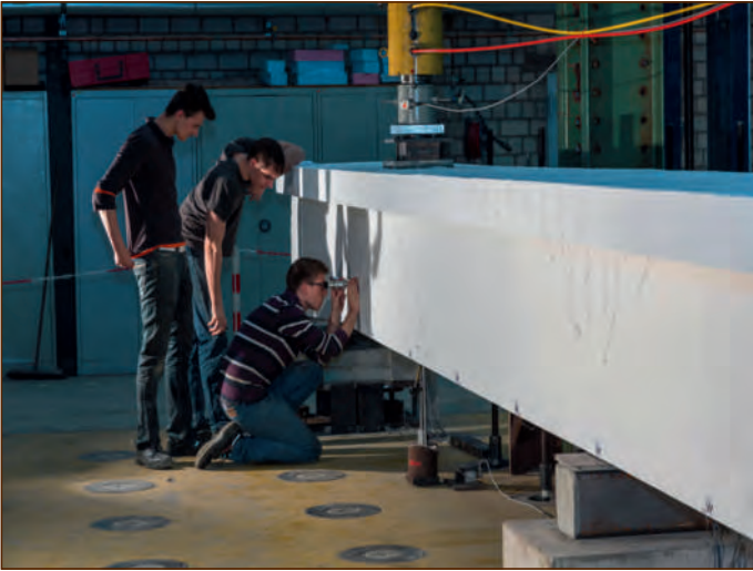
Abb. 9: Überprüfung der Rissbilder, Versuchsaufbau des Lehrstuhls Betonbau (Prof. Reinhard Maurer), Foto: Detlef Podehl
