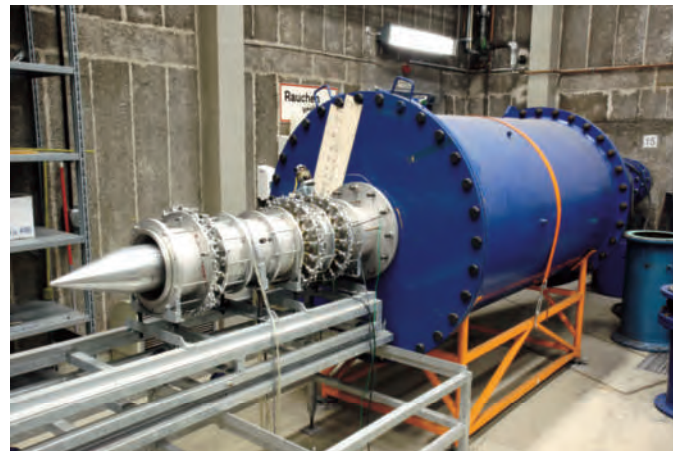
Ringgitterwindkanal zur Untersuchung rotierender Instabilitäten
