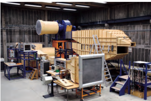
Großwindkanäle für die Untersuchung aktiver Beeinflussungsmöglichkeiten von Turbinenströmungen und Mischungsvorgängen
