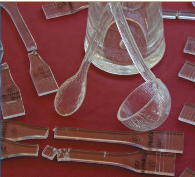
Haushaltswaren mit Spannungsrissen: Neuartige Prüfverfahren untersuchen z. B. die Spannungsrissbildung eines Werkstoffs mit dem Ziel, die Alterung von Kunststoffen zu bestimmen und Werkstoffe für eine längere Lebensdauer auszuwählen. (IKV/Winandy)
