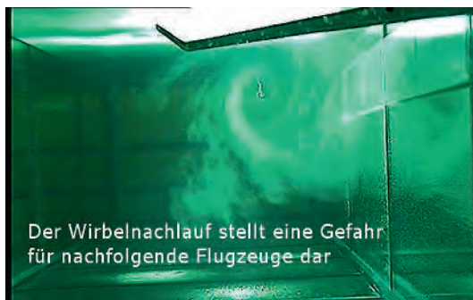
Abb. 6: Untersuchungen zur Wirbelschlepe an einem Halbmodell im institutseigenen Wasserschleppkanal
