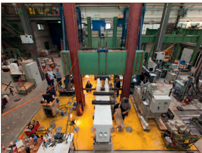
Abb. 7: Messungen an vorgespannten Betonträgern, Versuchsaufbau des Lehrstuhls Betonbau (Prof. Reinhard Maurer), Foto: Detlef Podehl
