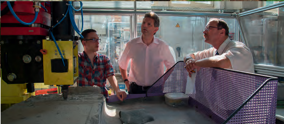
Schneidversuchsstand für Kraft- und Verschleißmessungen an Festgesteinen (Foto: W. Gaßner)
