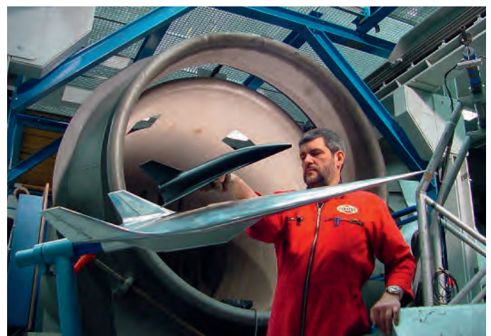
Abb. 4: In-house Windkanal, hier Modell-Untersuchungen eines wiederverwendbaren Raumtransportsystems
