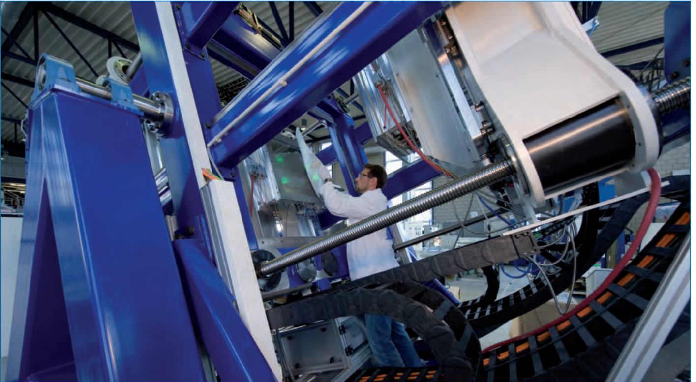
Das IKV arbeitet, wie hier im Bereich der faserverstärkten Kunststoffe (FVK), an innovativen Prozessen und neuen Technologien. Um die FVK auch für die Großserie konkurrenzfähig zu machen, müssen die Zykluszeiten reduziert werden. Auf diesem Weg ist die Spaltimpregnierung ein vielversprechendes patentiertes Werkzeug- und Verfahrenskonzept. (IKV/Winandy)
