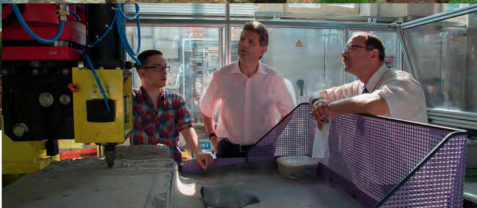
Schneidversuchsstand für Kraft- und Verschleißmessungen an Festgesteinen (Foto: W. Gaßner)
