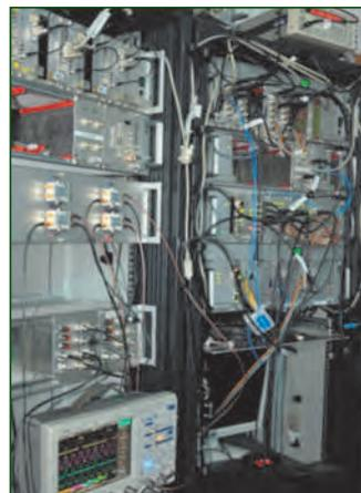
Demultiplexen des Strahlstroms (K. Groß)
