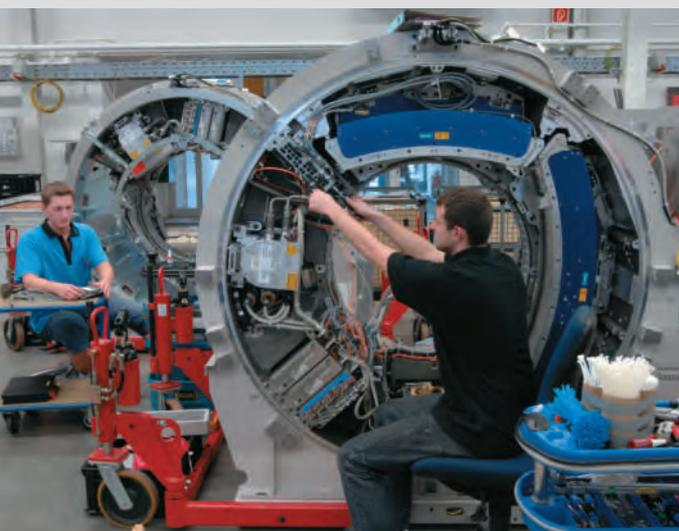
*Computertomograph ohne Gehäuse, im Aufbau befindlich
