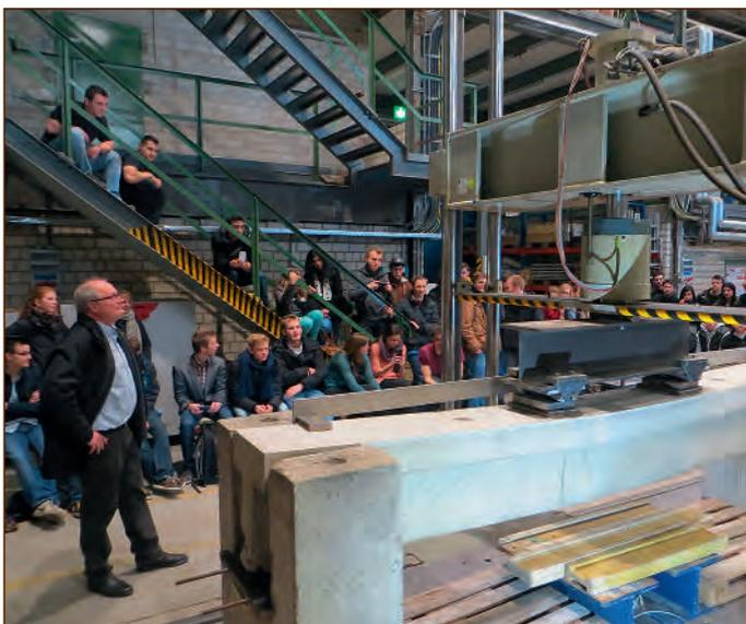
**Abb. 5:** Prof. Reinhard Maurer (Lehrstuhl Betonbau) führt den Studierenden des Bauingenieurwesens einen Belastungsversuch an einem Betonträger vor, Foto: Detlef Podehl
