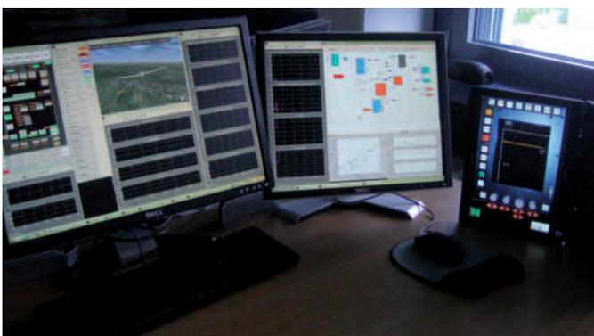
Bild 4: Arbeitsplatz zur Entwicklung von Flugregelungsfunktionen
