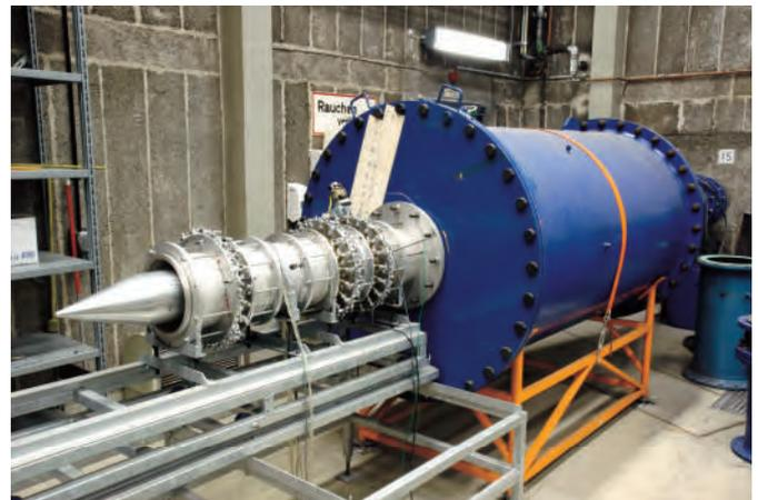
Ringgitterwindkanal zur Untersuchung rotierender Instabilitäten
