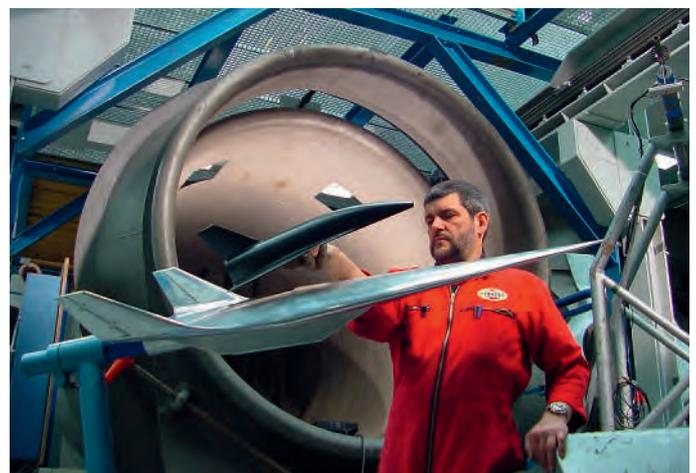
Abb. 4: In-house Windkanal, hier Modell-Untersuchungen eines wiederverwendbaren Raumtransportsystems
