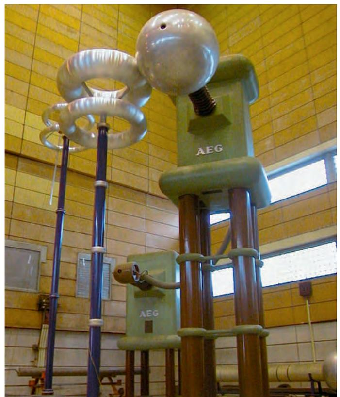
1,2-Millionen-Volt Wechselspannungstransformatorkaskade in der Großen Hochspannungshalle
