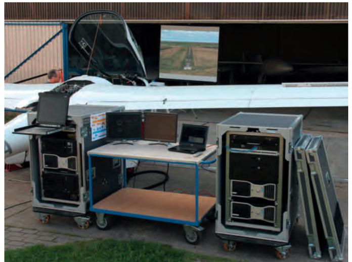
Bild 5: Hardware-in-the-Loop Simulator beim Test des Flugreglers
