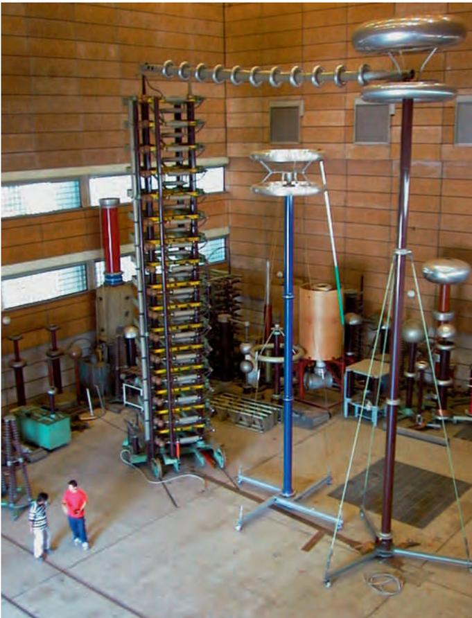
3,2-Millionen-Volt-Stoßspannungsgenerator in der Großen Hochspannungshalle
