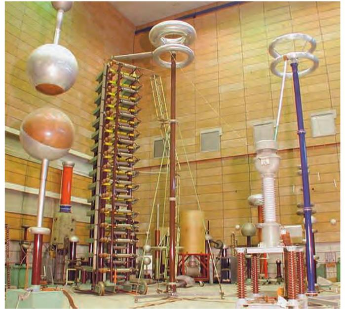
Stoßspannungsprüfungen an einem Messwandler
