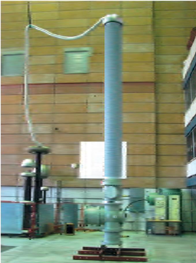
Prüfaufbau zur Untersuchung von Gleichspannungsisolatoren (gasisolierter Prüfkessel mit Freiluftdurchführung) an 600 kV Gleichspannung und 1,5 MV Stoßspannung
