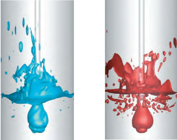
Simulation der Flüssig-Gas-Grenzfläche beim Tauchlanceinsatz in metallurgischen Prozessen bei geringerer Viskosität (links) und höherer Viskosität (rechts)
